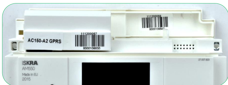
Obrázok 7: Poloha komunikačného modulu v meracom prístroji (príklad pre modul GPRS)
